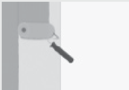
Abb. 1: Vollflächiges Aufbringen des fermacell Tiefengrunds
