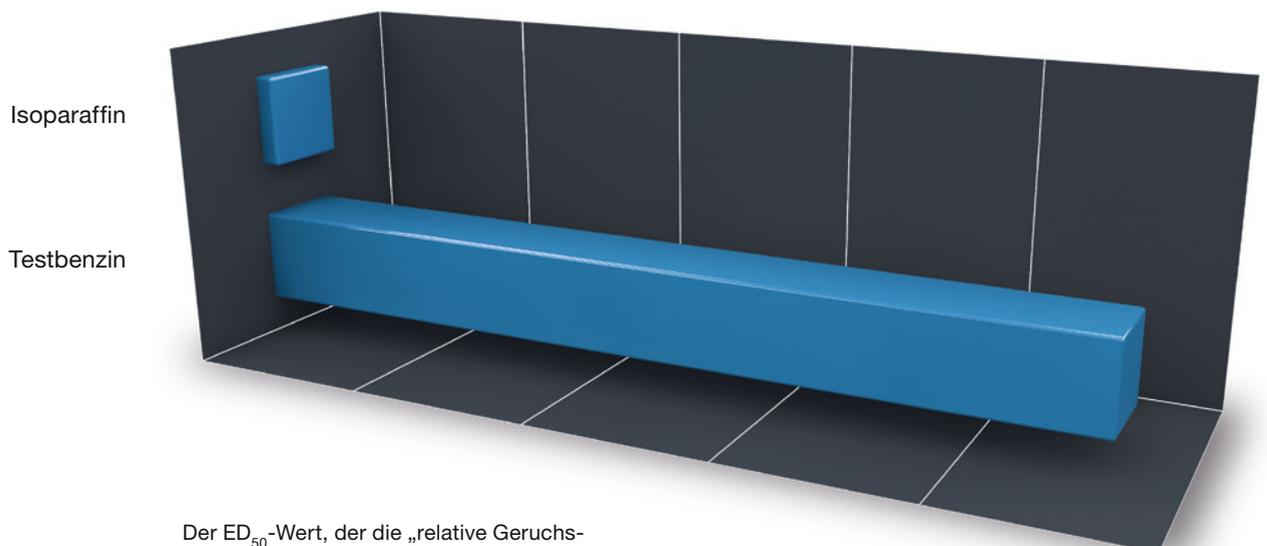
Der  $ED_{50}$ -Wert, der die „relative Geruchsstärke“ beschreibt, beträgt bei Isoparaffin nur etwa 1/60 des Wertes von Testbenzin.
