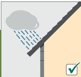
**Ausreichende Dachüberstände** sorgen für eine möglichst geringe, direkte Bewitterung der Fassade.
