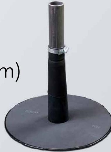
EPDM-Formteil zur Eindichtung von überstülpbaren Dachdurchdringungen mit rundem Querschnitt und mit Durchmessern von 35 bis 50 mm. Der Anschlusskragen besteht aus einem kreisförmigen Zuschnitt aus RESITRIX® SK W Full Bond mit einem Durchmesser von bis zu 30 cm.
