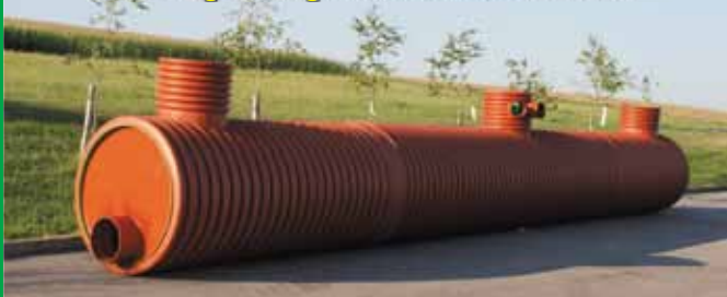
12 m Tank mit 3 Einstiegen, Zuläufe im Einstieg und gedrosseltem Ablauf
